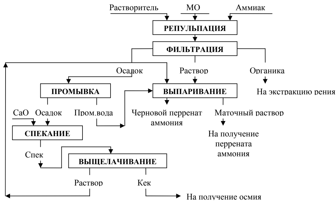
Рисунок – Технологическая схема переработки накопленных МО
